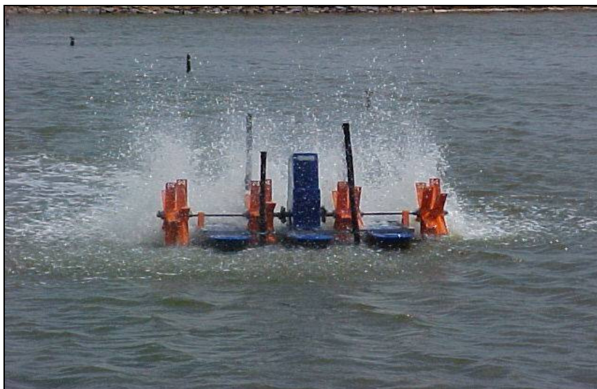
Figura 3.9 – Aerador Artificial
